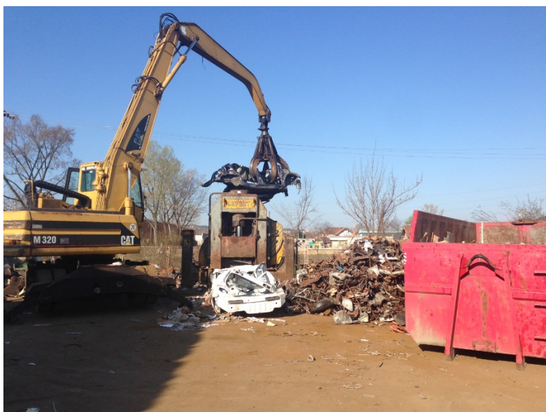
Slika 20: Mobilna presa za gvožđe, grajfer sa utovarnom rukom
