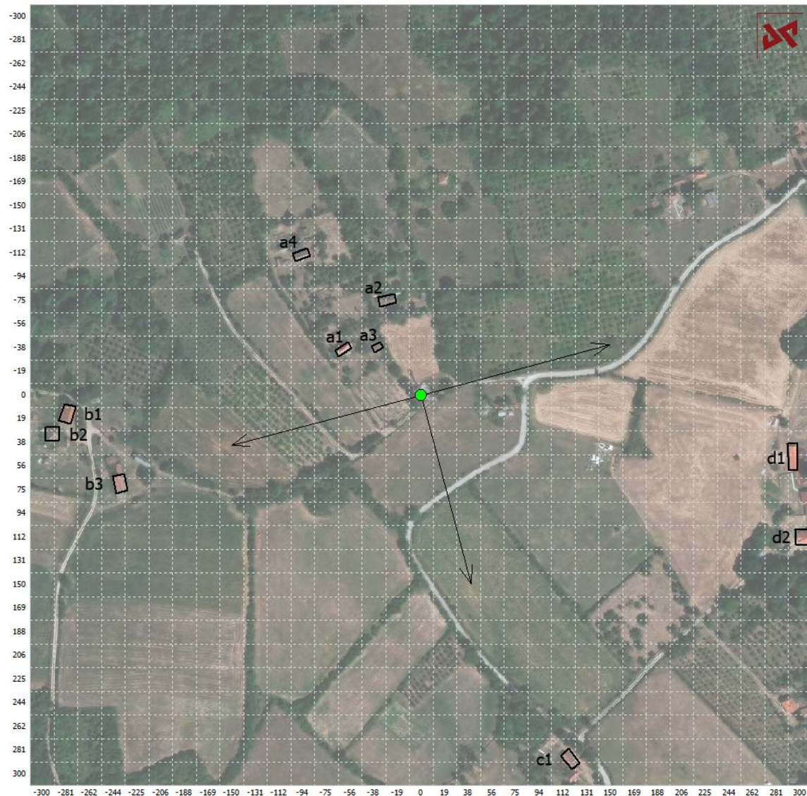
Slika 2.4 Prikaz pravaca zračenja antena bazne stanice i pozicije okolnih objekata
