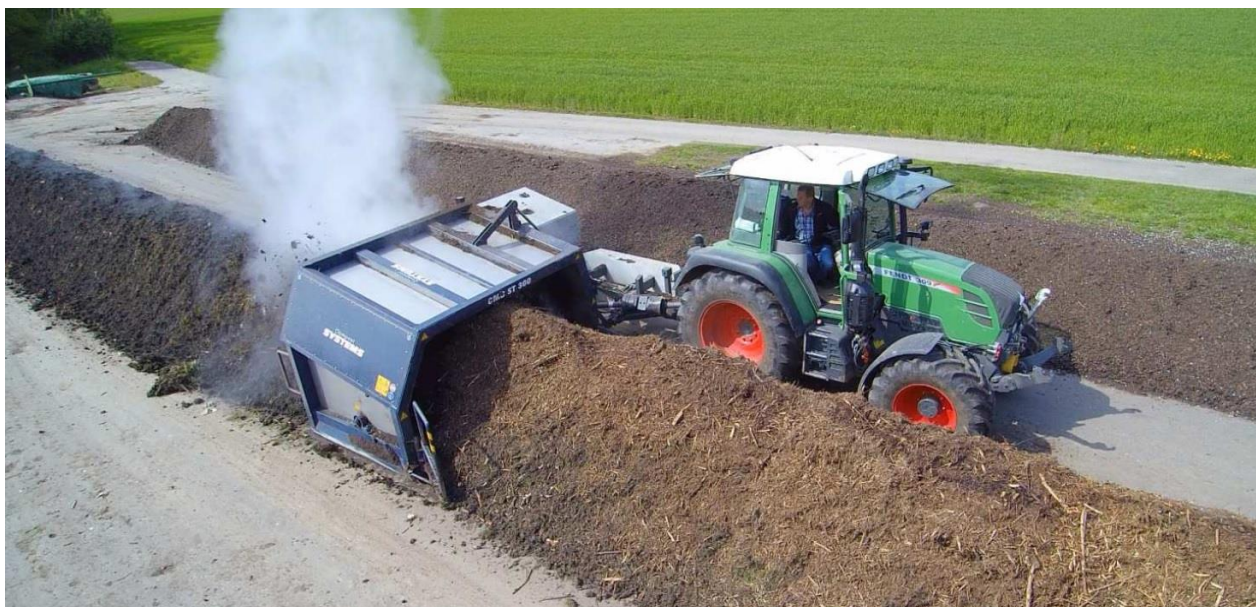
Слика 14.5.1-2. Трактор превртач у раду
