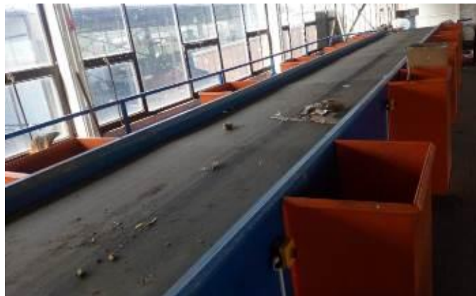
Слика 4.5.2-5. Платформа са траком за сортирање
