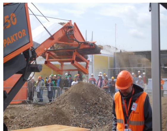
Слика 14.6-3. Машина/постројење за третман отпада од рушења и грађења (дробилица, магнетни сепаратор - слика лево и сито на крају конвејера (слика десно)
