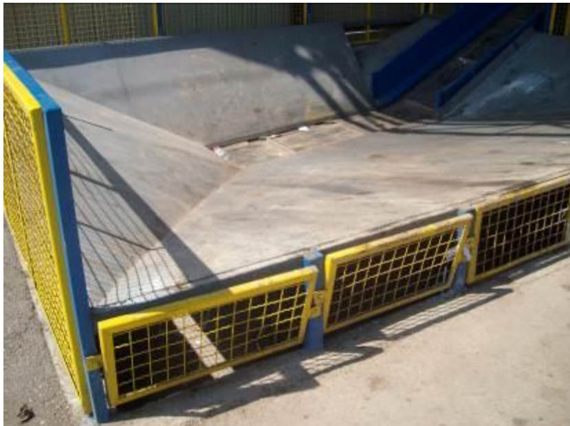
Слика 4.5.2-3. Усипни кош за рециклабилни материјал и прихватна трака на линији за селекцију отпада
