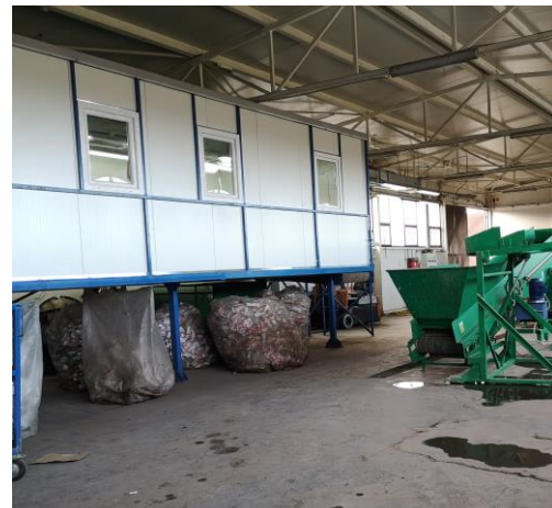
Слика 4.5.2-6. Сортирна линија са кабином контејнерског типа и траком за сортирање.
