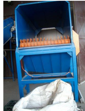
Слика 4.5.2-4. Коси тракасти транспортер и сепаратор за издвајање компоненти из отпада
