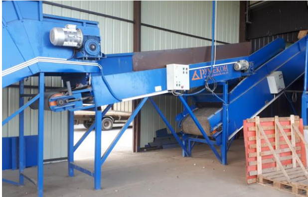
Слика 4.5.2-4. Коси тракасти транспортер и сепаратор за издвајање компоненти из отпада
