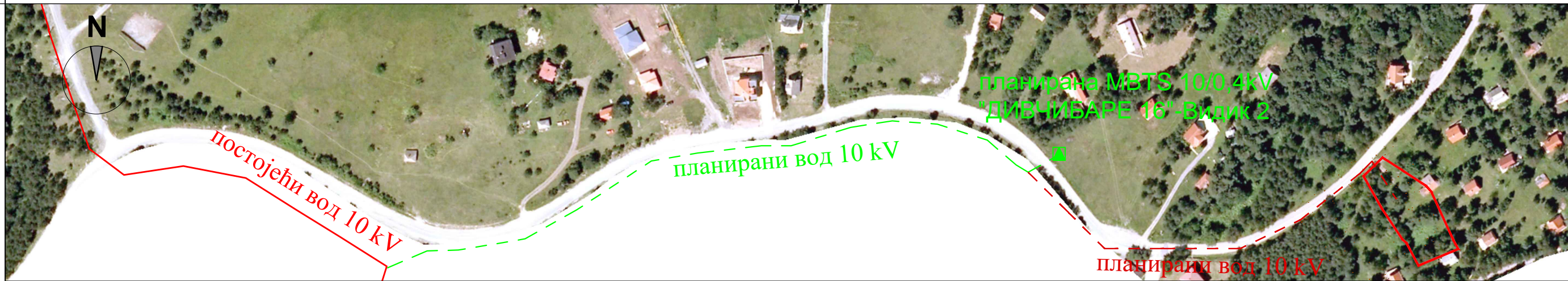
ПРИКАЗ ПРИКЉУЧЕЊА ОБЈЕКТА НА ПЛАНИРАНУ МВТС 10/0.4kV.....P=1:2500
